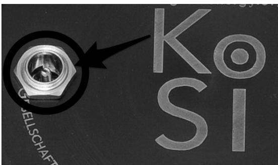
Stecke die Steckverbindung des mitgelieferten Netztes in die dafür vorgesehene Kontaktbuchse auf der Oberseite des KoSi Gerätes und den im Lieferumfang enthaltenen Netzadapter in eine 220V Steckdose.
